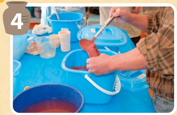
4 仕上がる作品の色や質感を想像しながら、釉薬かけ。工程の中で一番ワクワクする作業。この後、いよいよ1200℃で本焼き。
